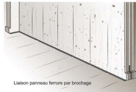
Exemple de liaisons spécifiques par plaques métalliques cachées
