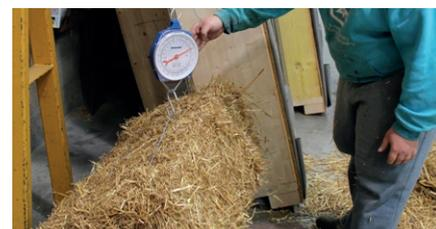
**La densité** doit être mesurée selon les préconisations du RFCP.
