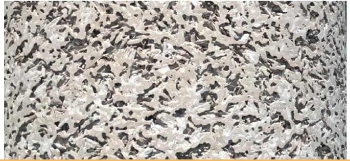
L'exploitation du chanvre pour la construction sert plusieurs usages. Les fibres de la plante sont extraites des tiges, et transformées sous forme de laine en rouleaux ou de panneaux isolants. L'intérieur de la tige, appelé chènevotte, est concassée en granules et peut être incorporée au béton ou à un enduit de chanvre.
