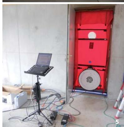
4&5 Réalisation des mesures d'infiltrométrie avec la porte soufflante sur l'échantillon de 3 logements. 6 Détail des éléments préfabriqués intégrant les vêtures.
