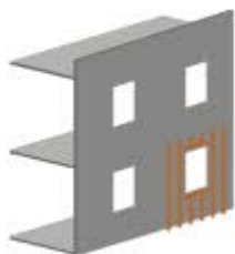
Isolation thermique extérieure (ITE)
